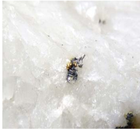
Рис. 2. Полированный образец жильного кристаллическизернистого кварца Любавинского месторождения с включениями золота и тетрадимита. Ув. 10 раз
