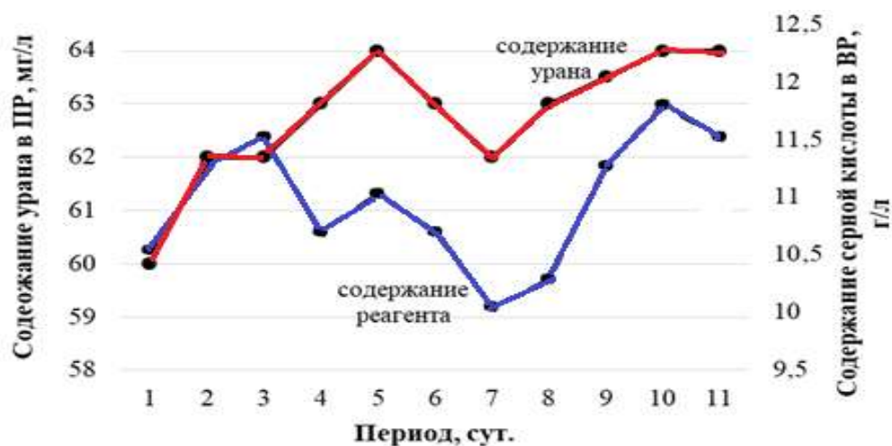
Рисунок 4.8 – Зависимость содержания урана в ПР от кислотности ВР в сегменте М – Н
