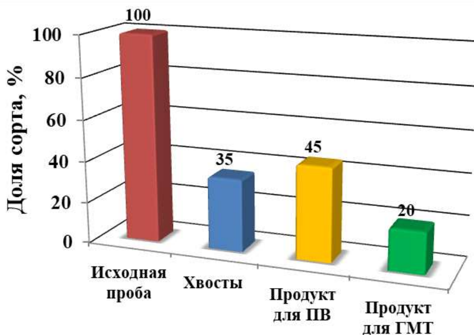
Рисунок 3.22 – Распределение горнорудной массы по сортам в процессе подземной рудоподготовки
