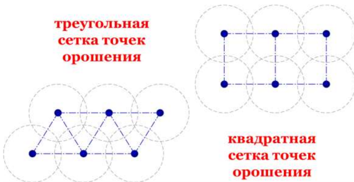
Рисунок 3.7 – Сетки расположения оросителей
