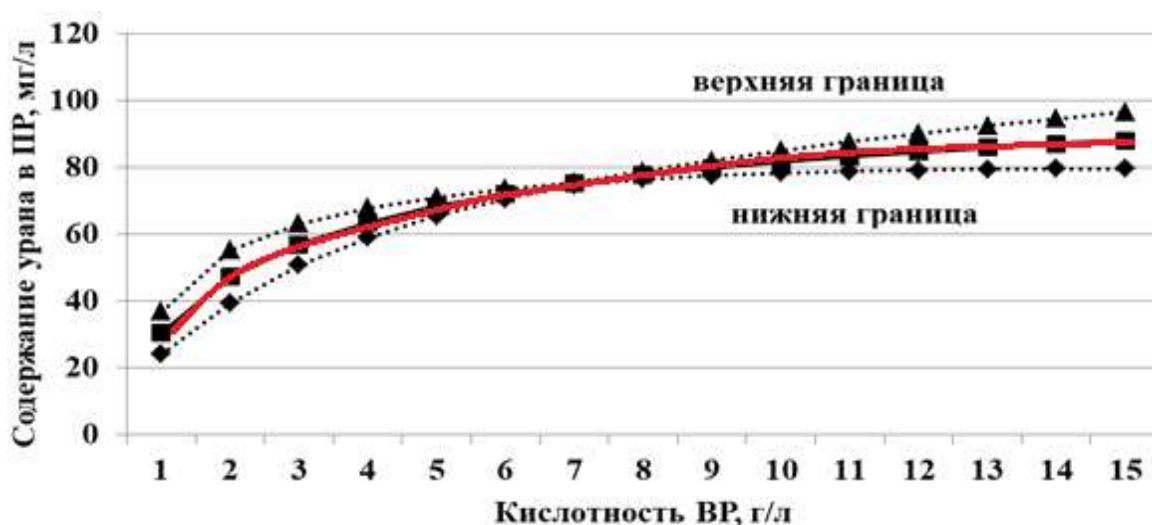
Рисунок 4.14 – Конечная зависимость содержания урана в ПР от кислотности ВР с доверительными интервалами для трахидацитов и базальтов (на примере камеры № 2 блока 4Д-701)
