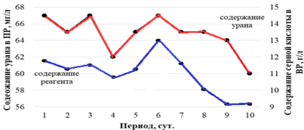
Рисунок 4.7 – Зависимость содержания урана в ПР от кислотности ВР в сегменте К – Л
