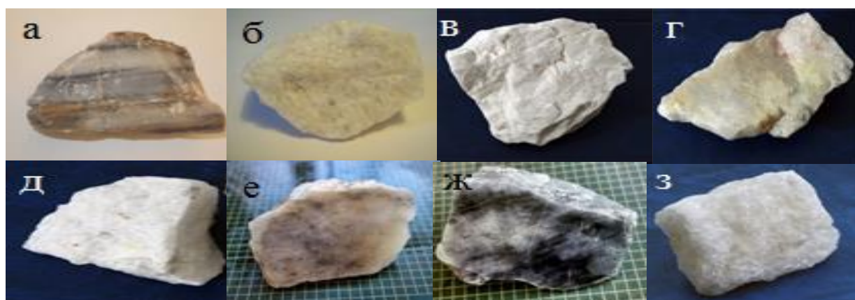
Рисунок 11 - Образцы кварцевого материала: а- кварциты участка Уренгенур, б- суперкварциты, в-мелкозернистый кварцит, г-сливной кварц, д-порфировидный кварцит, е –кварциты Урда-Гарганского участка первая разновидность (осветленный), ж- кварциты Урда-Гарганского участка вторая разновидность (углистые), з-гранулированный кварц Анахчи-Чипикетской группы жил
