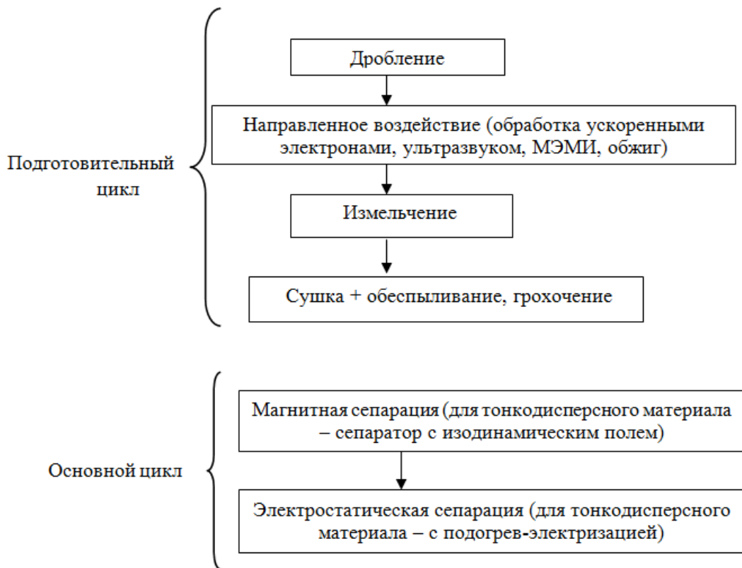
Рисунок 4.1.19 – Поцикловая реализация методов обогащения и переработки ЦСП
