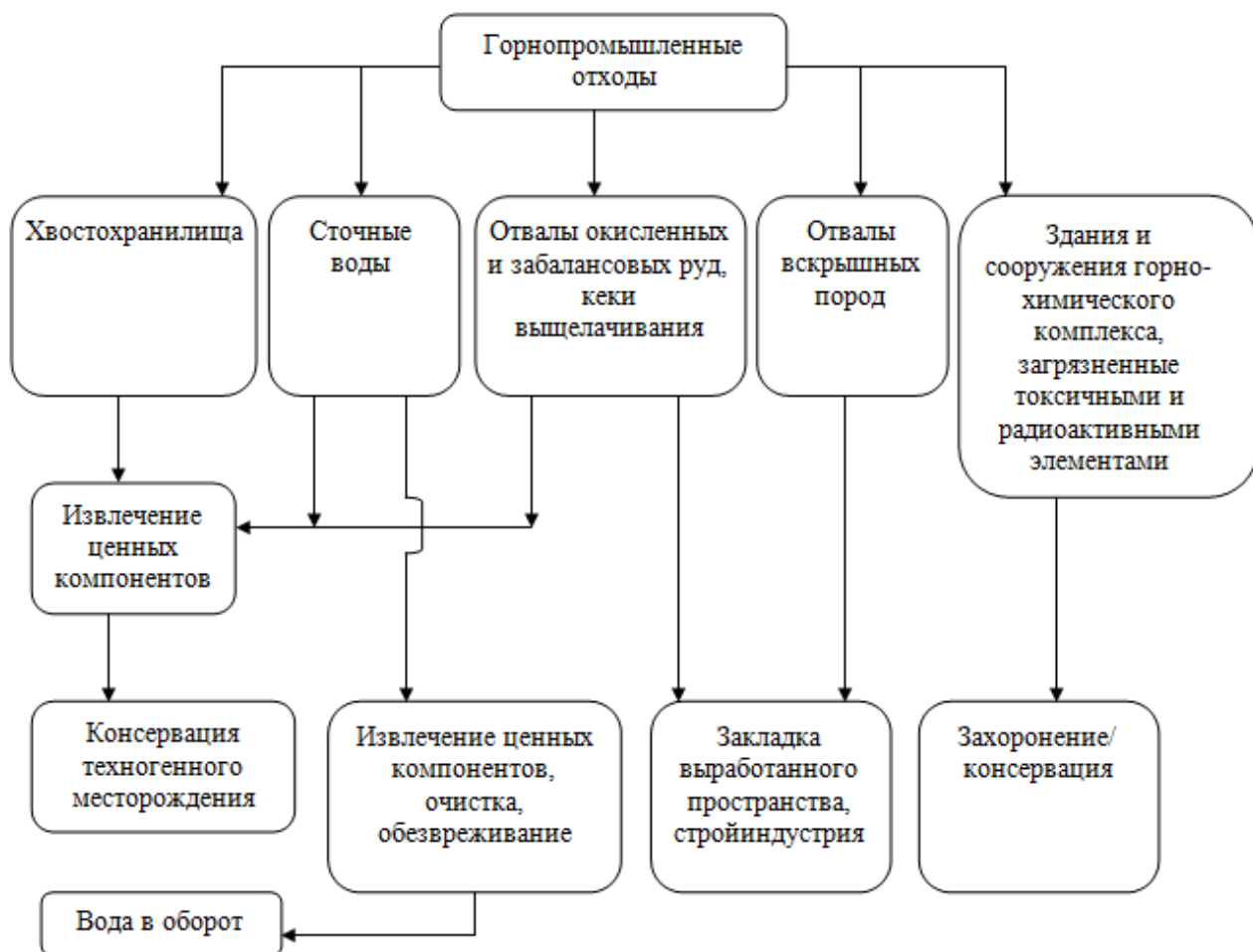
Рисунок 5.1.1 – Схема комплексного использования отходов горного производства
