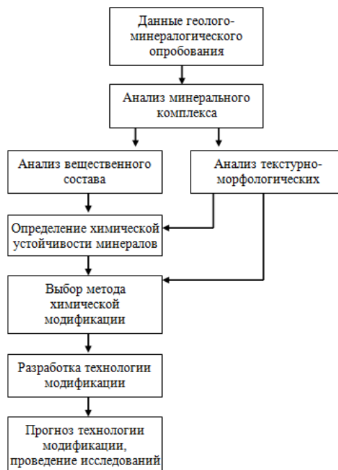
Рисунок 4.2.9 – Алгоритм выбора технологии химической модификации ЦСП
