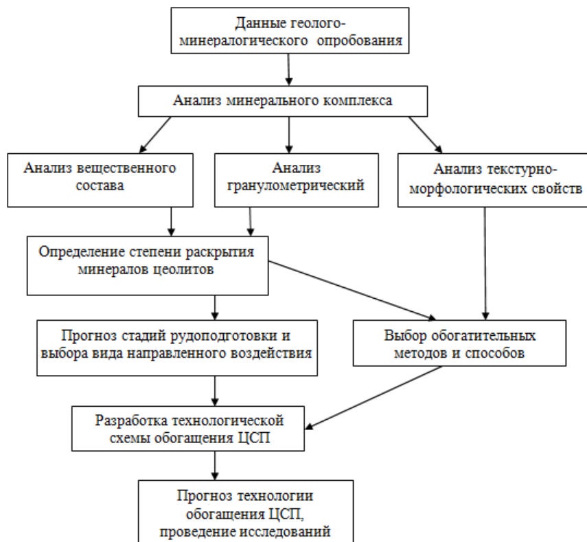
Рисунок 4.1.21 – Алгоритм выбора технологии обогащения ЦСП Восточного Забайкалья
