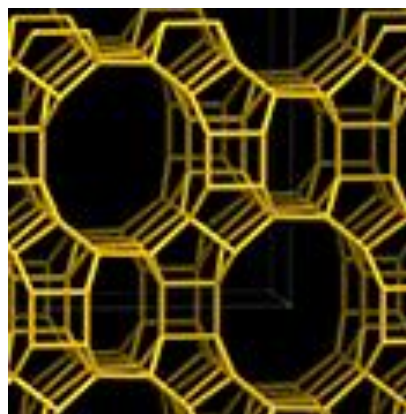
Рисунок 2.3.7 – Модель минерала морденита ЦСП Бадинского месторождения
