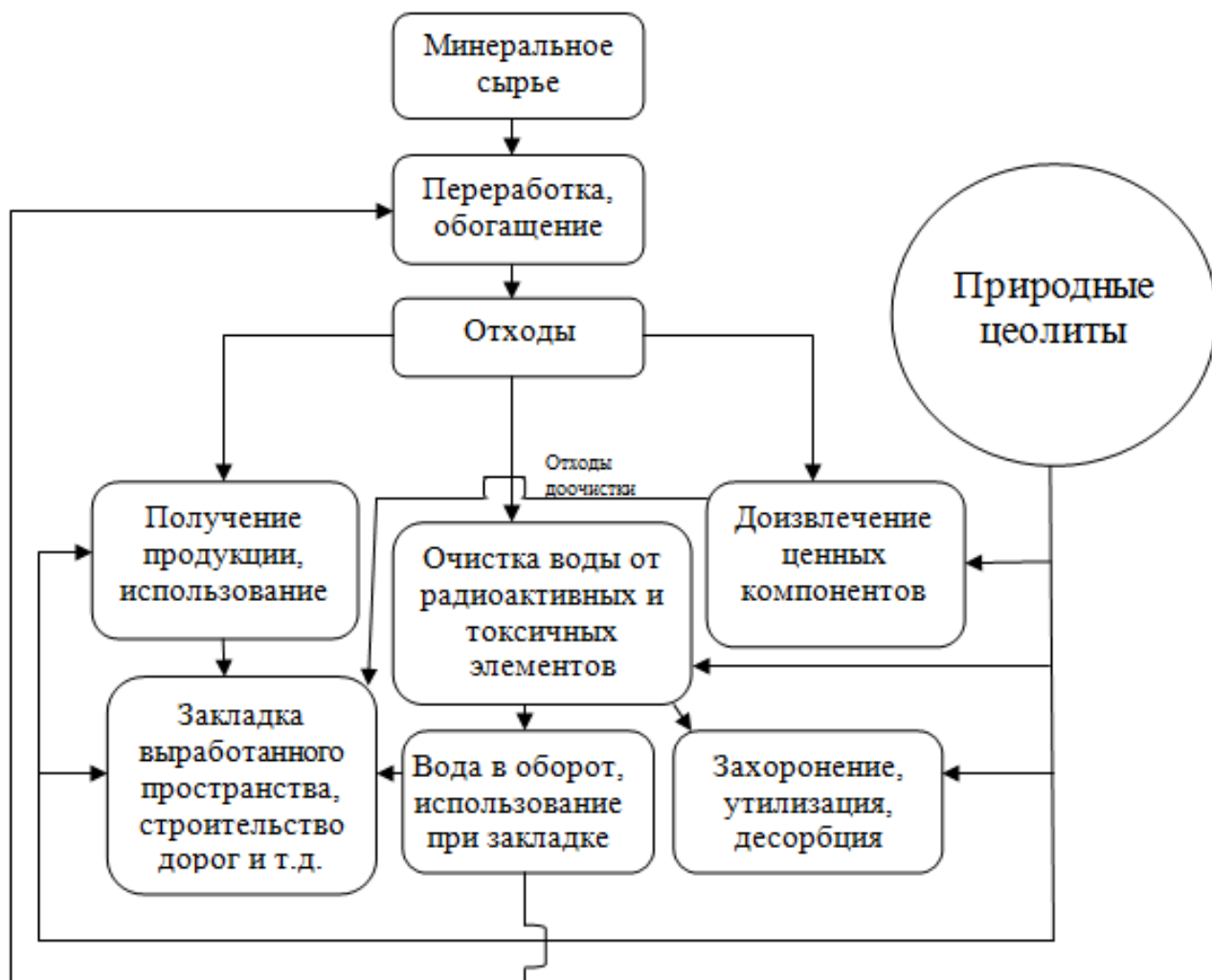
Рисунок 5.1.3 – Схема движения отходов горного производства с применением природных цеолитов
