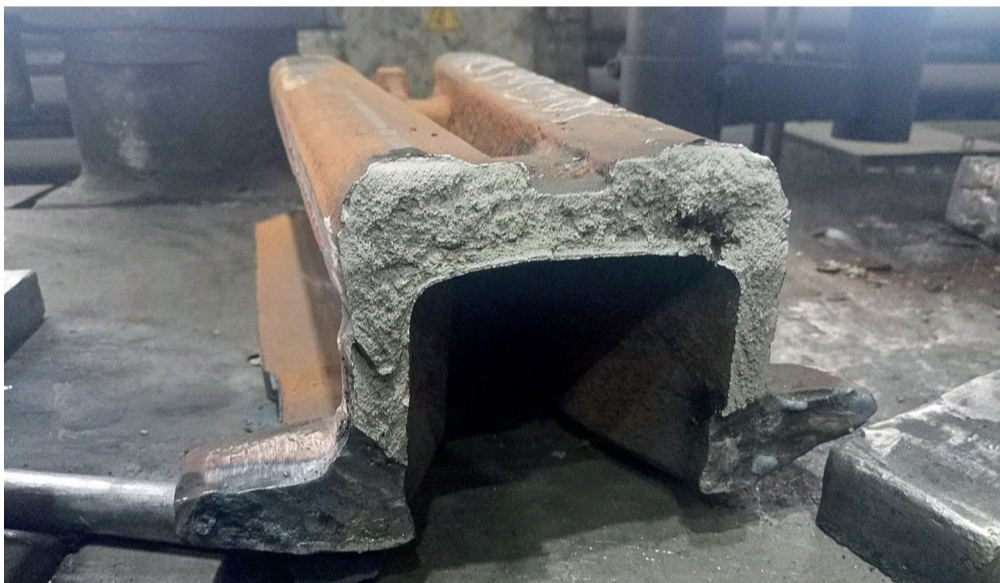
Часть поврежденного рельса
