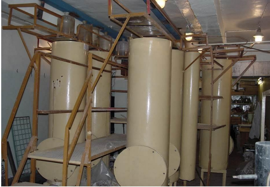
Рисунок 5.1 – Общий вид лабораторной установки для выщелачивания руд
