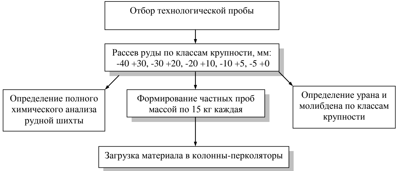
Рисунок 5.16 – Схема подготовки частных проб из технологической пробы
