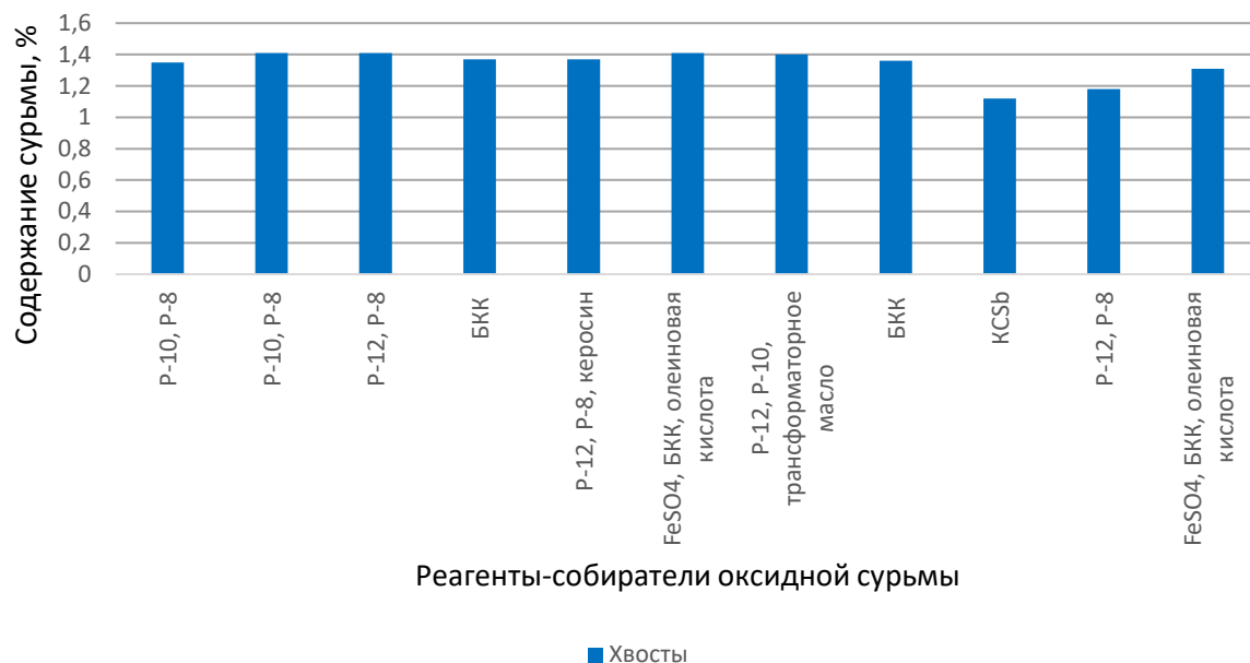
Рисунок 4.1 – Зависимость содержания Sb в хвостах флотации от типа реагента-собирателя оксидной сурьмы
