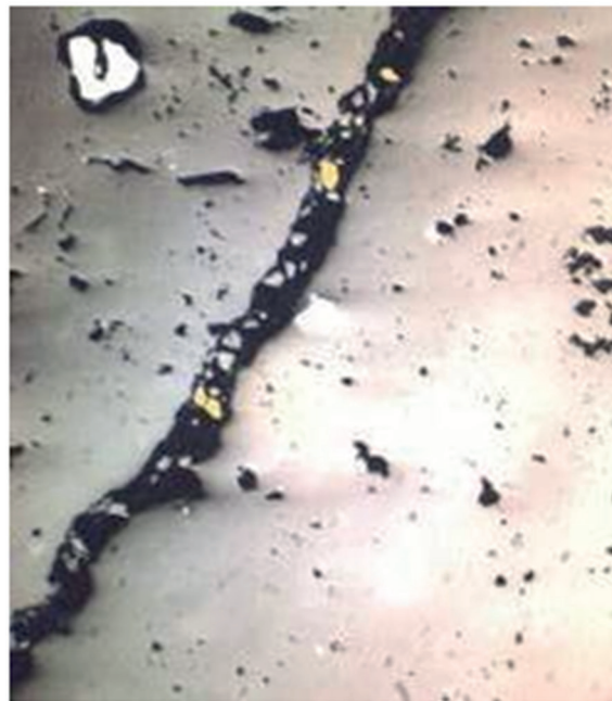
Рис. 3. Золото (желтое) в волосовидной трещине в пирит-содержащем кварце (белый пирит, серый кварц)
