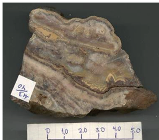
Рис. 2. Типичная ритмично-полосчатая текстура жильного кварца Дагайского блока. Канавка 3
