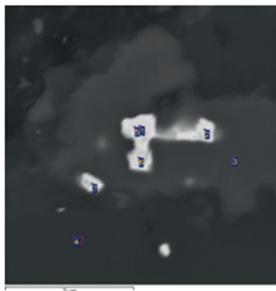
Рис. 1. Тонкое золото (1, 2, 5–7) в ассоциации с кварцем (4) и сидеритом. Электронно-микроскопический снимок
